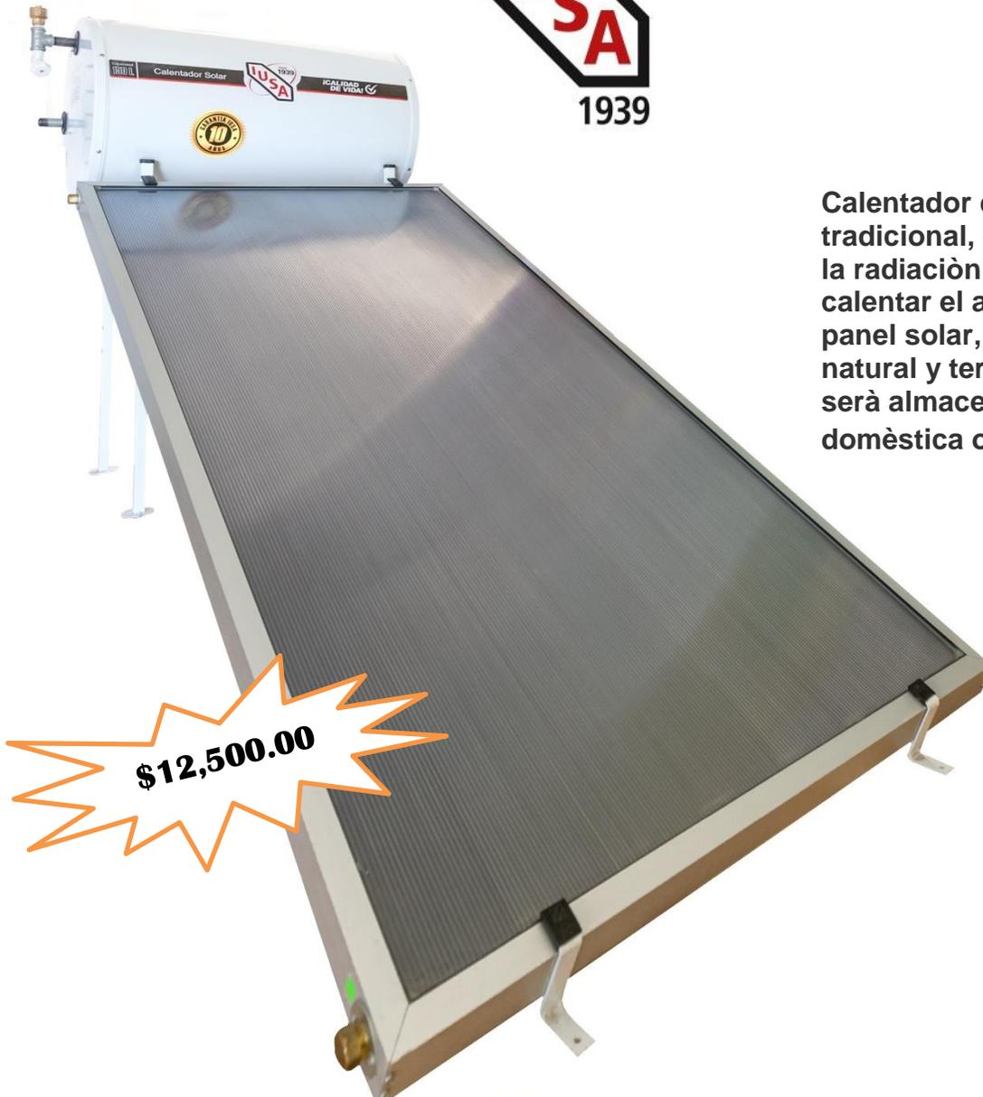
Calentador de agua alternativo al calentador de gas tradicional, el cual utiliza como fuente de energía la radiación solar directa, difusa y/o reflejada, para calentar el agua contenida en un colector o panel solar, enviándola por medio de circulación natural y termosifón a un termotaque en donde será almacenada, para su posterior utilización doméstica o industrial.
